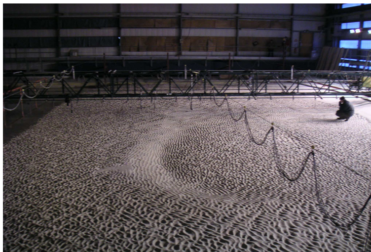
Figure 5 : Relevé bathymétrique le bassin vidangé.
