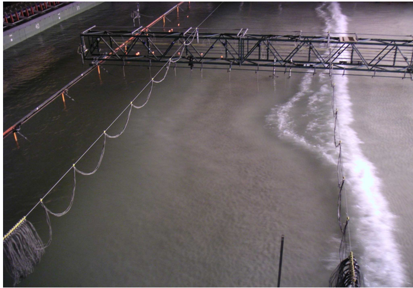
Figure 3 : Exemple de déferlement dans le bassin du LHF; vue de la passerelle de levé et des batteurs en haut à gauche de l'image.
