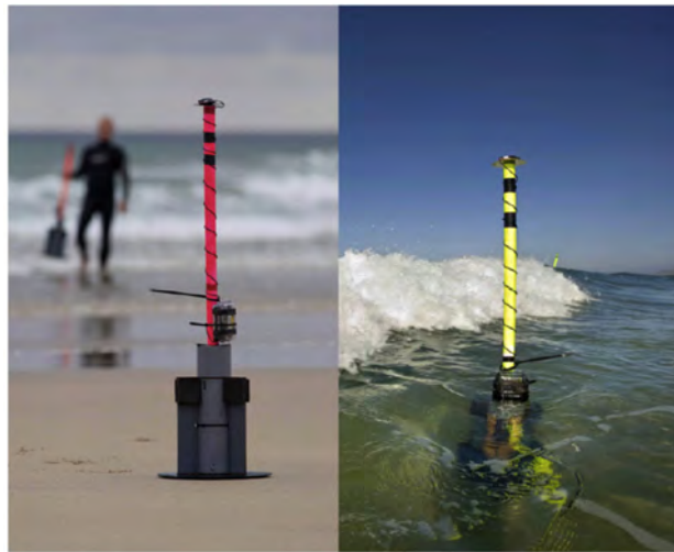
FIGURE 3.8 – Photos du même type de drifters utilisés pendant la campagne de mesures (d'après Scott et al., 2016 )
